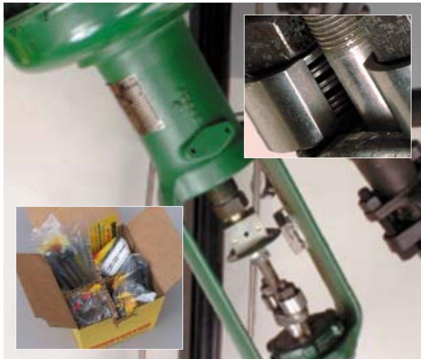
5800E WedgeSealは、Chestertonのユニークなウェッジ形状、成型シーリング・セットと477-1編組みカーボン・エンドリングを利用したパッキン・セットです。5800EセットはVOCの厳しい気化漏れ基準を満たしています。シーリング・リングのユニークなウェッジ形状が、グランド負荷をパッキンに効率よく転送し、セットがグランド調整に敏感に反応します。低システム摩擦なので、システムの変化にバルブが迅速かつ正確に反応します。パッキン・セットに含まれた腐食抑制剤が、電解点食を防止します。WedgeSealセットはまたAPI 589火災試験に合格しており、危険な環境で最高の安全性を保証します。
